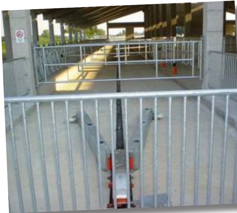
● I raschiatori a farfalla sono dotati di due "ali" raschianti incernierate sull'asse di traino centrale, che si aprono nella fase di avanzamento e pulizia e si chiudono nel percorso di ritorno a vuoto.
