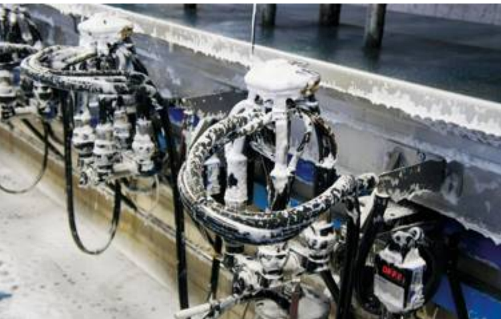
● Il lavaggio dell'impianto di mungitura è fondamentale, dal momento che attraverso esso passa il latte. Pertanto la detersione e la sanificazione vanno eseguiti con attenzione e cura.
